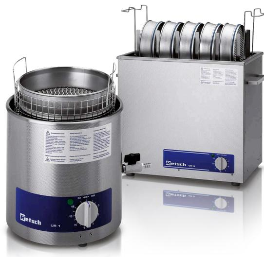
Диапазон приборов RETSCH включает в себя ультразвуковые ванны трех размеров для быстрой и легкой чистки контрольных сит и размольных гарнитур. UR 1 - для контрольных сит диаметром до 203 мм., UR 2 – для контрольных сит диаметром до 400 мм и UR 3 для одновременной очистки до 5 контрольных сит 200/203 мм диаметром. Бережная и, в то же время, полная очистка контрольных сит в ультразвуковой ванне увеличивает срок службы и предотвращает повреждения, вызванные ручной чисткой.
