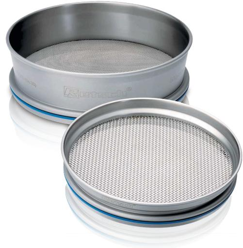
Надёжные проверенные временем лабораторные сита RETSCH имеют **прочную цельнопрессованную обечайку из нержавеющей стали**. Особое внимание уделяется точному размещению и равномерному натяжению ситового полотна. Индивидуальная лазерная гравировка каждого сита обеспечивает ясную и точную маркировку с возможностью полного отслеживания происхождения сита.
