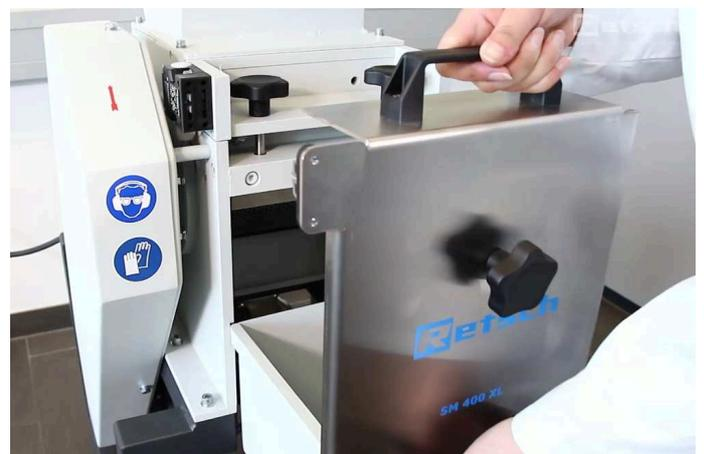
Мельница с размольной камерой объёмом 7.5 л подходит для измельчения образцов размером 170 мм x 220 мм. Мельница SM 400 способна измельчить большой объём материала за один подход, в то время как для других моделей режущих мельниц потребуется несколько этапов. Ручная предварительная резка образцов обычно не требуется.
