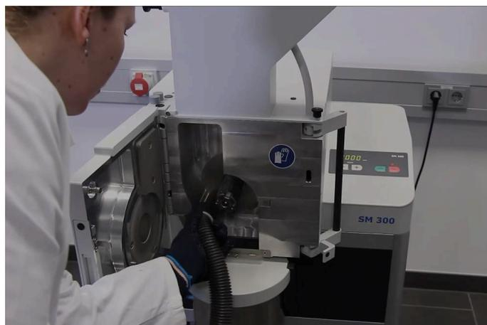
Быстрая и лёгкая очистка благодаря откидной воронке, которая обеспечивает полный доступ к размольной камере, гладким внутренним поверхностям и ситовой вставке без кассеты и краёв, где мог бы застрять материал.
