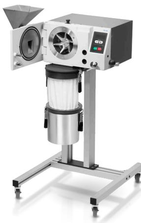
Роторная ударная мельница SR 300 подходит для предварительного и тонкого измельчения. Она может обрабатывать **сухие, мягкие, средне-твердые органические и неорганические материалы**. Для улучшения выгрузки образца и для обработки термочувствительных образцов, вместо выгрузки под действием силы тяжести опционально можно использовать циклонно-вытяжную систему.
