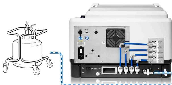
Установка 1: Дополнительное устройство sruoPad и резервуар для работы с жидким азотом.
