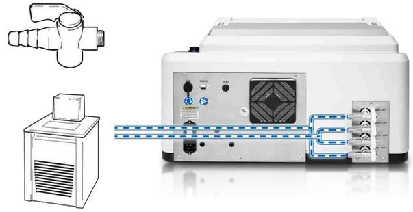
Установка 2: Работа с внешним устройством нагрева и охлаждения, например, водопроводным краном, охладителем или термостатом.
