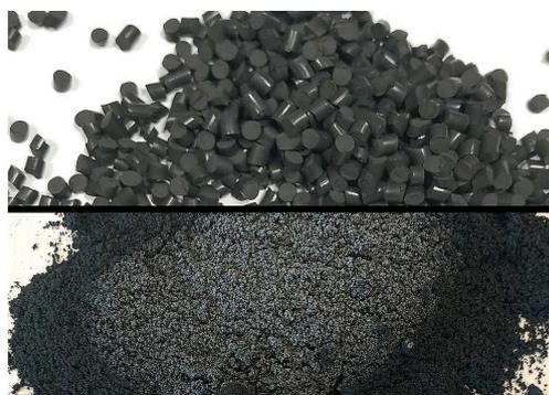
Быстрое измельчение черного флюорокарбонового каучука (FKM) путем охрупчивания образца в двух стаканах по 125 мл при температуре  $-100^{\circ}\text{C}$ .
