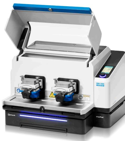
**MM 500 control - это высокоэнергетическая лабораторная шаровая мельница, которая может использоваться для сухого, мокрого и криогенного измельчения с частотой до 30 Гц. Это первая на рынке мельница, которая позволяет отслеживать и контролировать температуру процесса измельчения.**
