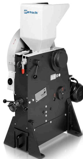
Щёковая дробилка ВВ 200 — напольная модель с производительностью до 300 кг/ч, подходящая для многих задач дробления. Начальный размер частиц до 90 мм, ширина щели между щёками может быть установлена бесступенчато от 0 до 30 мм.
